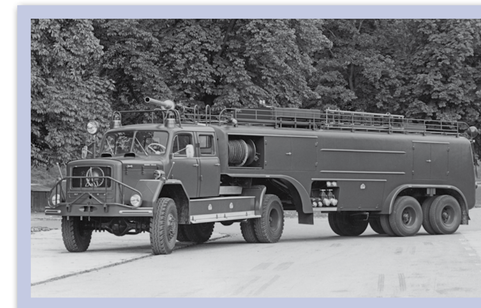
D 1968: Einer der vier Magirus „FLF 24“ in Sattelschlepperausführung, die nach Algerien geliefert werden GB 1968: One of the four Magirus "FLF 24" semitrailer crash fire rescue vehicle delivered to Algeria I 1968: Uno dei quattro veicoli antincendio aeroportuali Magirus "FLF 24" forniti in Algeria F 1968: Un des quatre véhicules aéroportuaires Magirus "FLF 24" livré en Algérie
