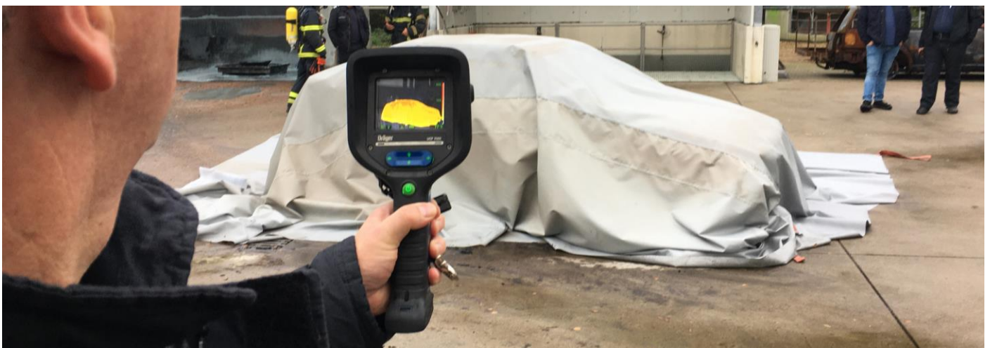
Bild: KfV Segeberg - Einsatz einer Löschdecke im Brandfall
