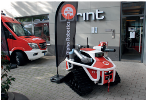
Der Löschroboter "Alpha Wolf R1" von der Firma Alpha Robotics soll die Einsatzkräfte der Zukunft bei asymmetrischen Einsatzlagen unterstützen.
