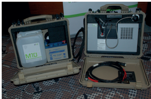
Die tragbare Batterie von SFC Energy basiert auf Brennstoffzellentechnologie
