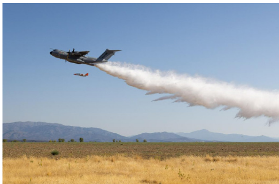
Das Kit zur Feuerlöschung erfordert keine Änderungen am Flugzeug.
